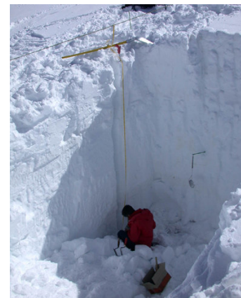
Abb. 6: Schneeschart zur Untersuchung des Dichte- und Temperaturverlaufs im Testfeld
