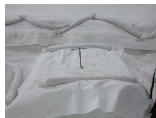
Abb. 5: Testfelder zur Messung der Abschmelzung bei Aufbringung verschiedener Geotextilien
