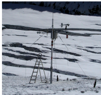
Abb. 4: Wetterstation zur Messung der Energiebilanz am Gletscher
